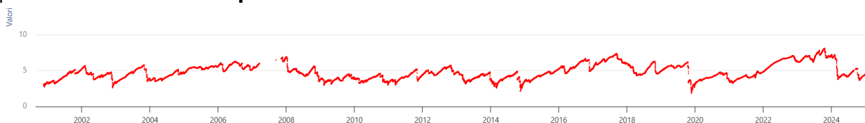
Figura 13 trend piezometrico pozzo di riferimento
